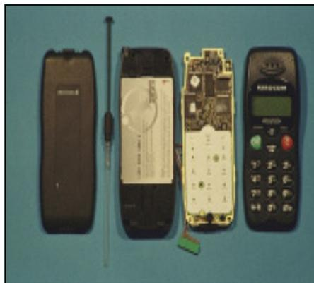
Vue éclatée d'un téléphone portable - Source : CNRS
