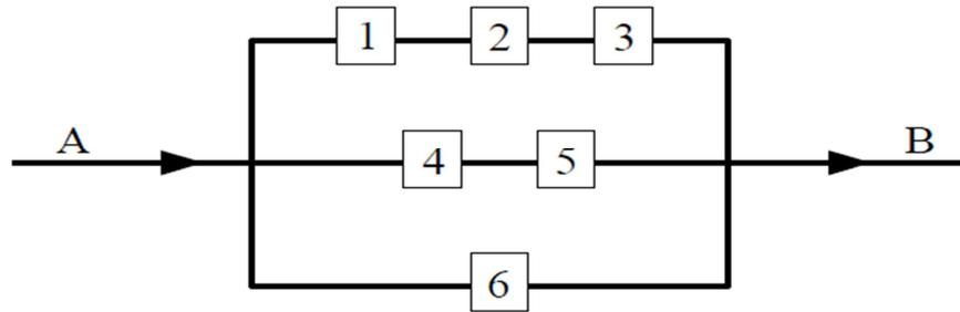
On considère un système hydraulique comportant trois canalisations sur lesquelles sont montées six vannes, numérotées de 1 à 6 et disposées comme l'indique la figure ci-dessus ; ces vannes contrôlent l'écoulement de l'eau entre le point A et le point B.
