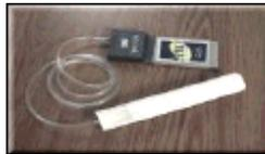
Le spiromètre: cet appareil mesure la capacité pulmonaire.
