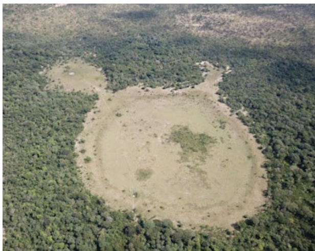
Ronds de sorcière au Brésil correspondant à des émanations d'hydrogène Crédits : Isabelle Moretti
